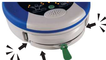
Figura 4. Inserción de un Pad-Pak
