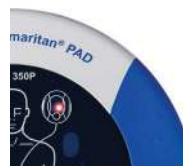
Figura 10. Indicador luminoso intermitente en rojo o pitido; consulte la sección Resolución de problemas del Apéndice B.
